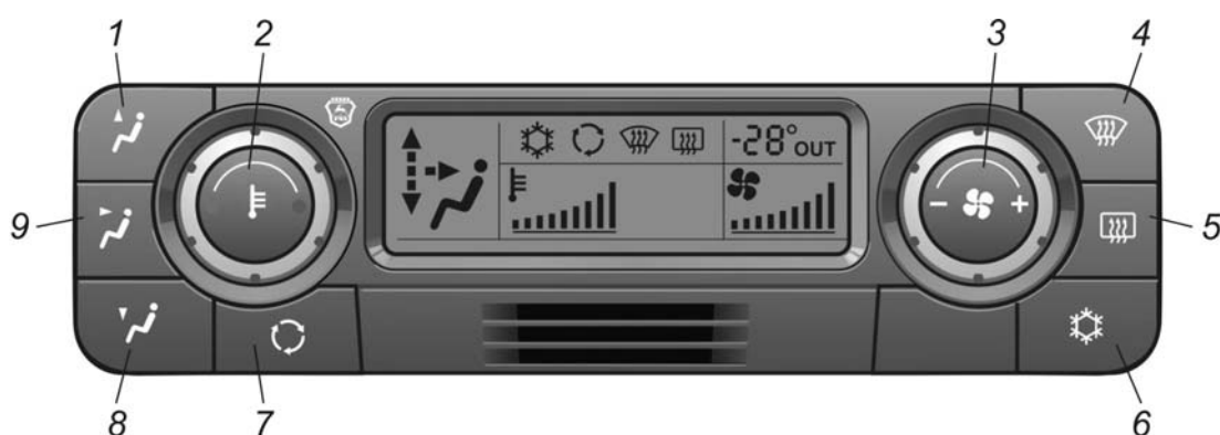
Рис. 8.1. Пульт управления отопительно-вентиляционной и климатической установкой
